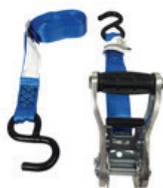
Cinta de 3m p/ fixação de carga com catraca manual (carga máx. 227 Kg / ruptura 681 kg) aço galvanizado
