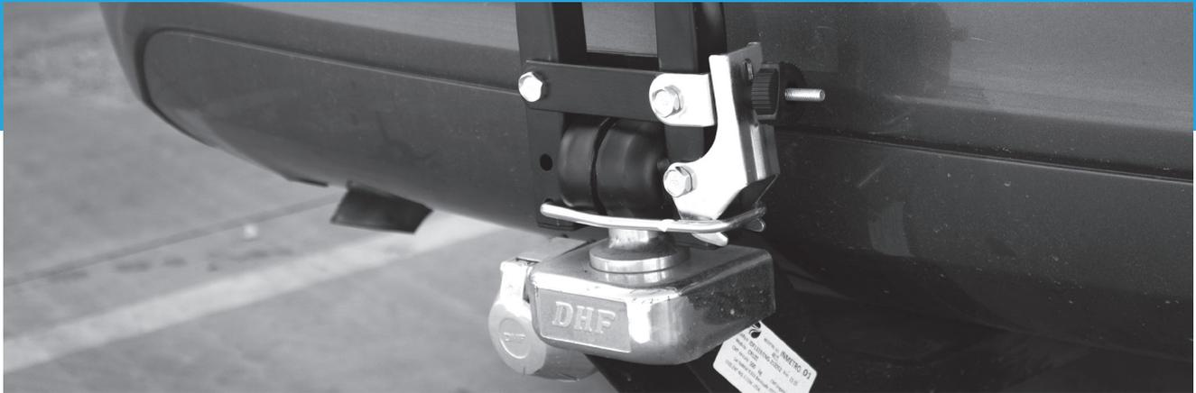
Suporte desenvolvido para uso em esferas de 50mm e montagem no engate traseiro. Suporta até 60kg e comporta até 3 bicicletas, desde que não ultrapasse a carga permitida.
