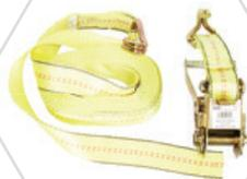
Cinta de 8m p/ fixação de carga pesada com catraca manual (carga máx. 1.500 Kg / ruptura 4.540 Kg) aço galvanizado
